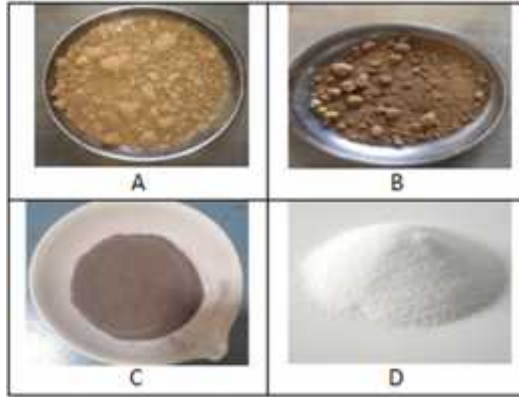
Fig. 1. (A) clayey soil, (B) lateritic soil, (C) marine clay, (D) sodium chloride salt
