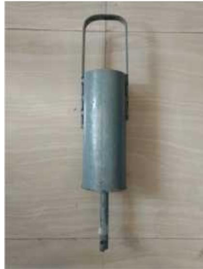
**Fig. 6.** Sand pouring cylinder.
