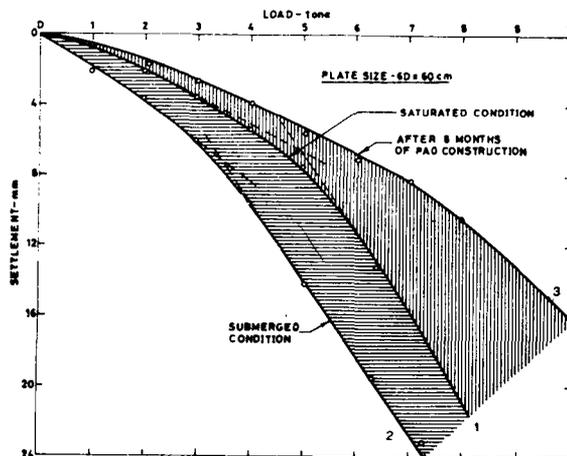
FIG. 27 LOAD SETTLEMENT CURVES ON WEAK CLAY LAYER
