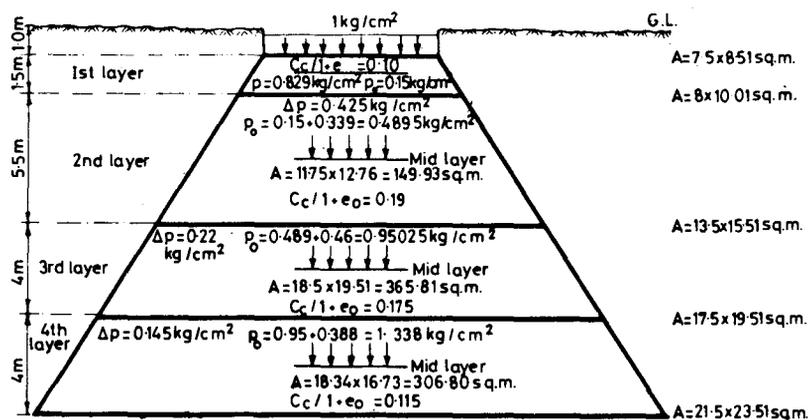
Fig.42 COMPUTATION OF CONSOLIDATION SETTLEMENT OF THE VIRGIN GROUND
