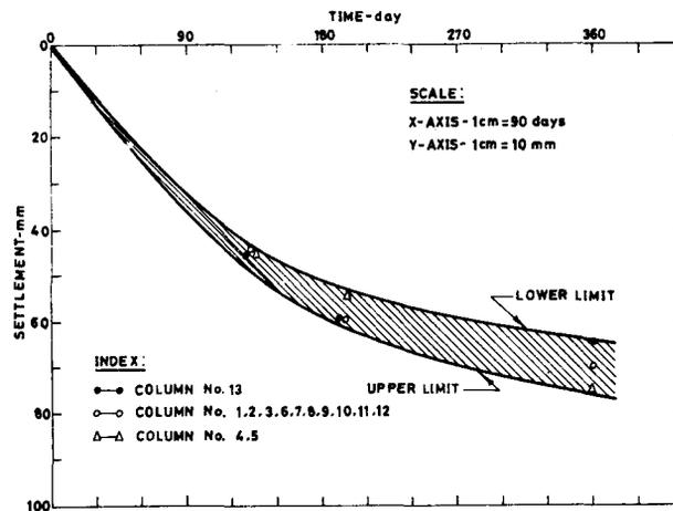
FIG.35: TIME-SETTLEMENT CURVE FOR BUILDING BLOCK-G10
