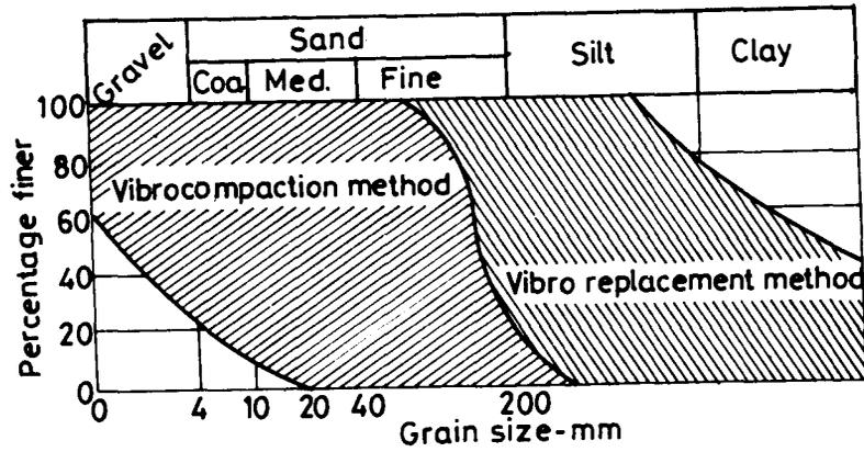
Fig.3 RANGE OF SOILS SUITABLE FOR STABILIZATION
