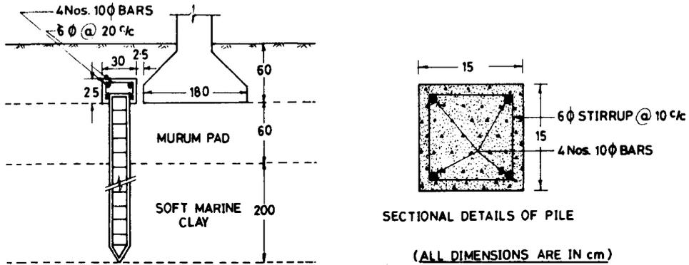
FIG. 39(b): SECTION-AB SHOWING THE DETAILS OF THE SKIRTING EDGE BEAM AND THE FOOTING
