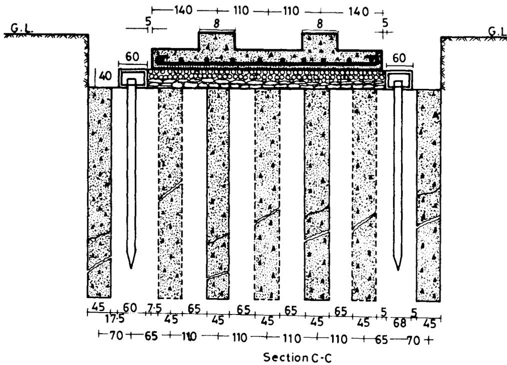
Fig. 45 SKIRTED GRANULAR PILE FOUNDATION
