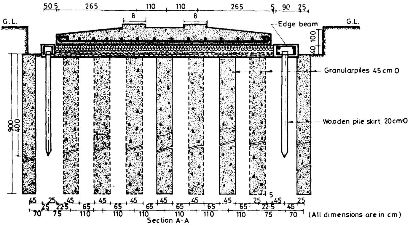
Fig. 44 SKIRTED GRANULAR PILE FOUNDATION
