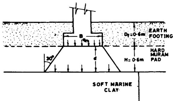
FIG. 29 FOUNDATION ON HARD MURUM PAD UNDER LAIN BY SOFT MARINE CLAY ( AFTER TOMLINSON 1986)
