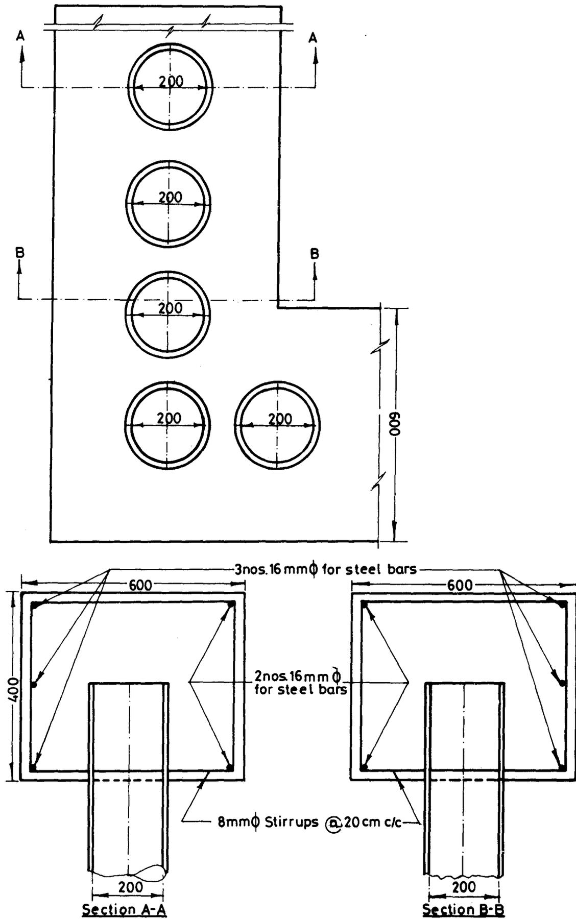
Fig.48 DETAILS OF TIMBER PILES / PIPE PILE SKIRTING
