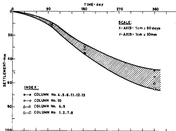
FIG.36: TIME-SETTLEMENT CURVE FOR BUILDING BLOCK-K2
