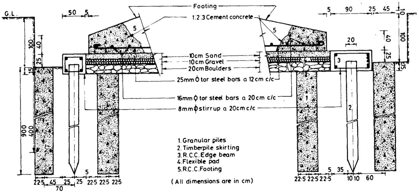
Fig.46 DETAILS OF EDGE BEAM & TIMBER PILE SKIRTING
